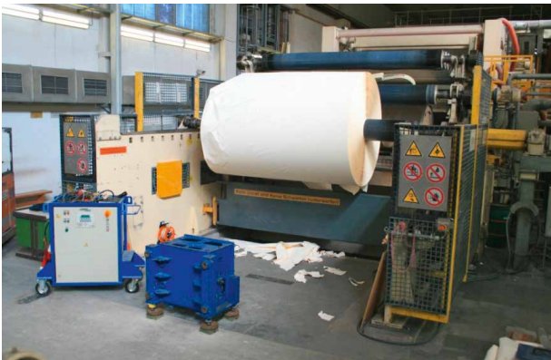
Dynamische Anregung des Fundamentrahmens einer Papiermaschine
