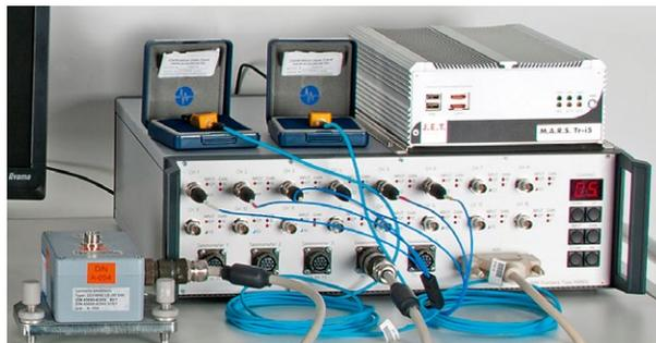
Rechnereinheit, Messdatenerfassungseinheit und Sensorik
