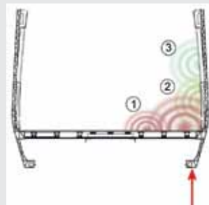
Rechnerische Prognose der Beiträge des Luftschalls (links) und des Körperschalls (rechts) von Boden ①, unterer Seitenwand ② und oberer Seitenwand ③
