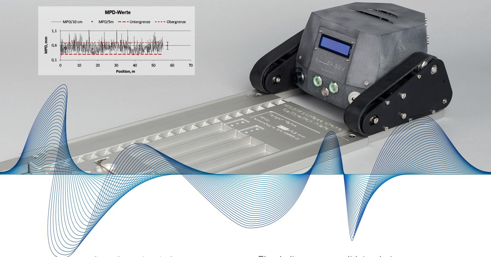
**surface drone** ist ein ferngesteuerter Messroboter zur Messung und Bewertung der Mikro- und Makrotextur von Fahrbahnoberflächen.
